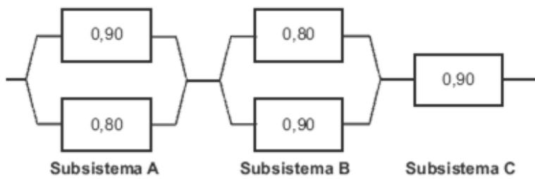
Considere o diagrama acima, formado por três subsistemas, representando a estrutura operacional de um sistema eletrônico. A probabilidade de cada componente operar adequadamente está explicitada no diagrama.
