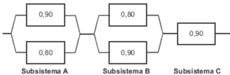
Considere o diagrama acima, formado por três subsistemas, representando a estrutura operacional de um sistema eletrônico. A probabilidade de cada componente operar adequadamente está explicitada no diagrama. Para que o sistema funcione, é necessário que o subsistema C e pelo menos um dos componentes de cada um dos subsistemas A e B funcionem. Supondo-se que os componentes operem de forma independente, a probabilidade de que o sistema funcione é
